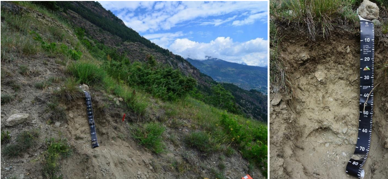
Fig. 4.7.2.1,2: Skeletic Calcisol (Hypocalcic) in an eroded slope nera Pont d'Aël, Valle di Cogne (vda18 P10).
